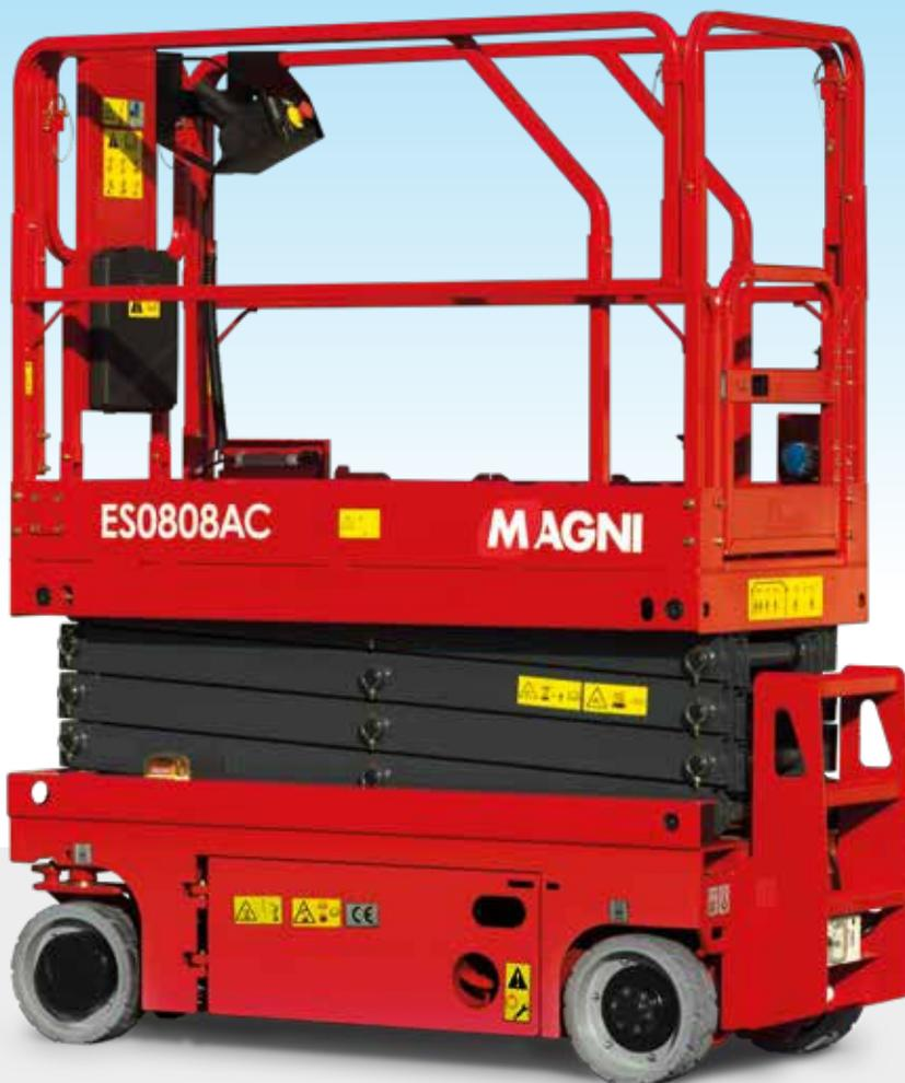
Dieses Modell ist mit vollelektrischen Fahrtrieb ist robust und trotzdem einfach in der Bedienung und Wartung. Das Hubsystem der Elektroschere ist energiesparend, emissionsfrei und geräuscharm. Es ist ideal für den Einsatz in Innenräumen geeignet. Die kompakte Bauweise und die Außenmaße ermöglichen ein müheloses Durchfahren von Standardtüren und gewährleisten somit maximale Flexibilität
