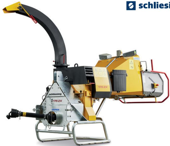
Der 175 ZX macht als klassischer 3-Punkt-Heckaufbau 540 U/min., verfügt über eine Freilauf-Gelenkwelle, ein schwenkbares, geräuschgedämmtes Ausblasrohr, eine starke 2-Messer-Hackscheibe und eine PowerGrip Einzugswalze mit hydraulischem Einzug. Bei einer Einzugsbreite von 24 cm zerkleinert er spielend leicht Stammholz bis 16 cm Durchmesser. Empfohlen für Motoren mit einer Leistung von 18 bis 36,8 kW (25 bis 50 PS).
