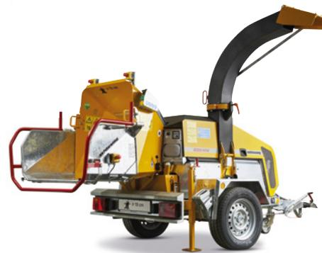
Der elektrische 235 MX-E ist der Allrounder unter den Buschholzhackern und frisst sich durch fast jede Herausforderung im Garten- und Landschaftsbau. Seine robuste Bauweise und die einfache Handhabung machen ihn zu einem zuverlässigen Partner mit universellem Anwendungsspektrum. Der Asynchronmotor mit einer Leistung von 21 kW und einem Drehmoment von 67 Nm ermöglichen ein müheloses Arbeiten bei Stammdurchmessern bis zu 19 cm. Die Akkumulatoren sind für einen vollen Arbeitstag ausgelegt.
