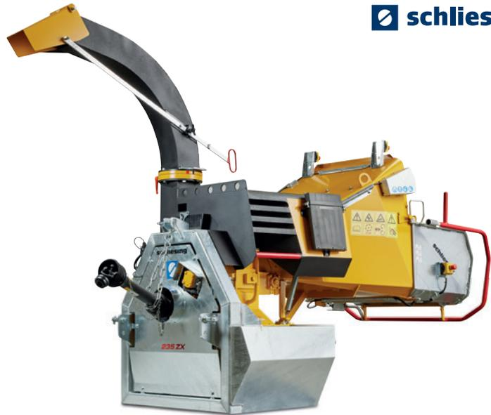
Für die Zerkleinerung von Ästen und Stämmen bis 19 cm Durchmesser ist der Zapfwellen-Häcksler 235 ZX immer eine hervorragende Wahl. Trichterklappe und das schwenkbare Ausblasrohr sind ebenso vollverzinkt wie der Ponton. Für den Betrieb ist eine Antriebsleistung von 29 bis 51,5 kW (40 bis 70 PS) notwendig.
