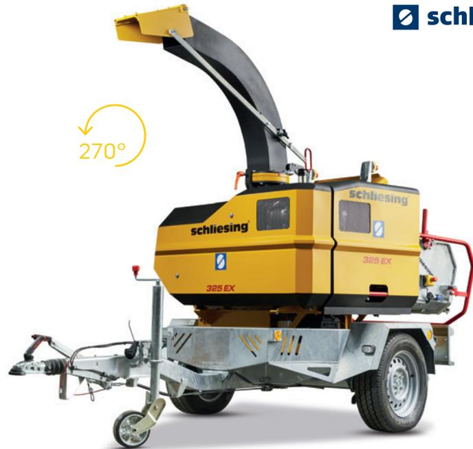
**Der 325 EX-D ist ein echter Produktivitätsturbo. Kein Wunder, verfügt er doch über einen kraftstrotzenden Stage V 4-Zylinder Common-Rail Turbodiesel von Kubota, einen um 270° schwenkbaren Einzugsstrichter und ein Hackwerk, das einen Stamm von 20 cm Durchmesser zerkleinert wie ein Streichholz. Ebenfalls am Bord: Zugeinrichtung mit Auflaufbremse und Soft-Dock Kugelpkupplung oder DIN Zugöse.**
