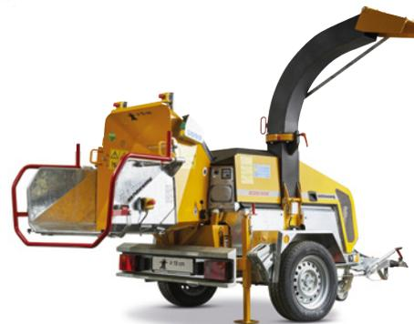
**Die Schliesing-Mittelklasse gibt es ab sofort auch als Elektrohäcksler. Der kraftvolle Asynchronmotor mit einer Leistung von 25 kW und einem Drehmoment von 120 Nm garantiert ein produktives Arbeiten mit gewohnter Durchzugsstärke. Die Akkumulatoren sind für einen vollen Arbeitstag ausgelegt. Emissionsloses häckseln bei geringer Geräuschentwicklung und kompromissloser Produktivität für Stammholz bis 20 cm Durchmesser.**
