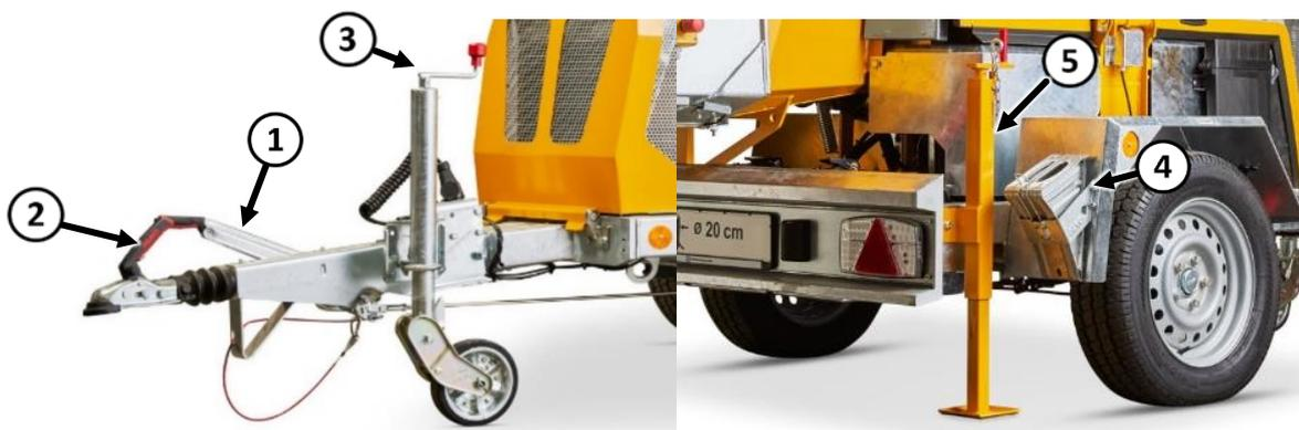
Anschließend wird das Stützrad so ausgerichtet, dass sich der Fahrwerksrahmen der Maschine in Waage befindet. Zuletzt ist die hintere Kurbelstütze **⑤** soweit herunter zu kurbeln, dass diese Kontakt zum Boden hat und mit dem zugehörigen Splint zu sperren. Die Maschine hat nun einen sicheren Stand.
