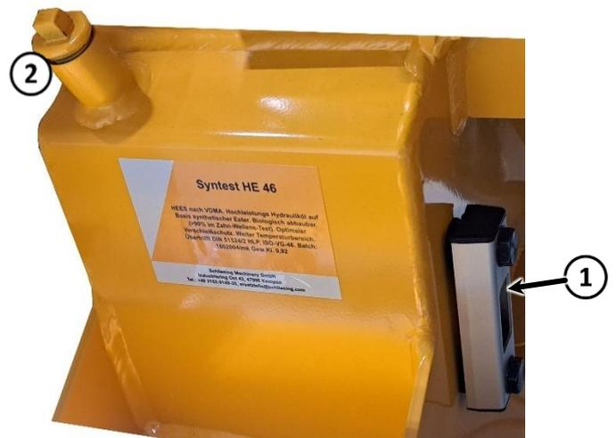
Spätestens alle 400h ist das Öl vollständig zu erneuern. Dazu wird das System durch die Ölablassschraube ab Boden des Hydrauliktanks entleert und durch den Einfüllstutzen aufgefüllt. Das Altöl ist entsprechend umweltbewusst zu entsorgen. Mit dem Ölwechsel ist auch der Hydraulikölfilter zu tauschen.
