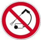
An den kritischen Stellen der Maschine, dort wo nicht mit Wasser gereinigt werden darf, befinden sich Hinweise in Form von Piktogrammen. Diese sind bei Unleserlichkeit zu ersetzen. Somit soll eine Beschädigung der empfindlichen Komponenten ausgeschlossen werden. In diesen Bereichen ist die Maschine nur mit trockener und ölfreier Druckluft zu reinigen. Siehe auch Abschnitt PIKTOGRAMME.
