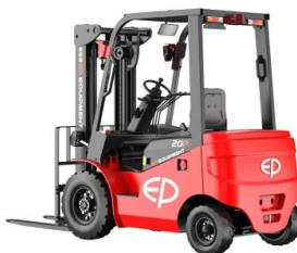
Innen- und Außenanwendung: Mit einem robusten Design ist der EFL203(P) elektrische Gabelstapler ideal für Innen- und Außenanwendungen. Alle Wetter- und Gelände: Große Reifen, hohe Bodenfreiheit und wasserdichte Konstruktion machen ihn zu einer Allwetterlösung für unebenes Gelände. Lange Betriebszeiten: Eignet sich für anspruchsvolle Szenarien, die nahezu 24/7-Betrieb mit der Gelegenheit zum Laden der Li-Ion-Batterie und großen Batteriekapazitätsoptionen erfordern.
